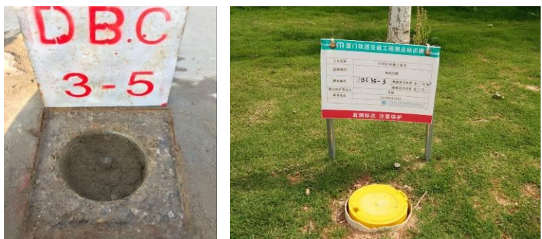
图 5.5-2 周边地表沉降监测点埋设实景图
