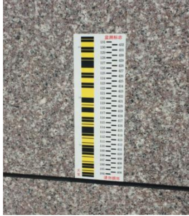
图 5.6-2 沉降反射条码标志埋设示意图
