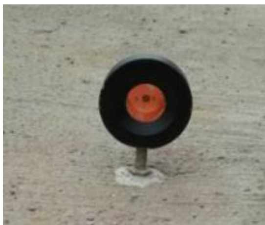
图 5.3-1 边坡水平位移测点布设示意图
